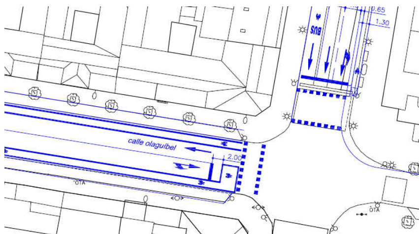
Ejemplo de una plataforma avanzada de espera (calle Olaguibel)
