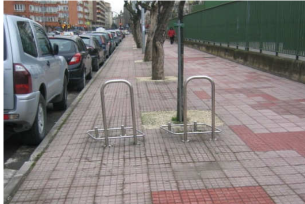
Ubicación inadecuada de un aparcabici en la acera
