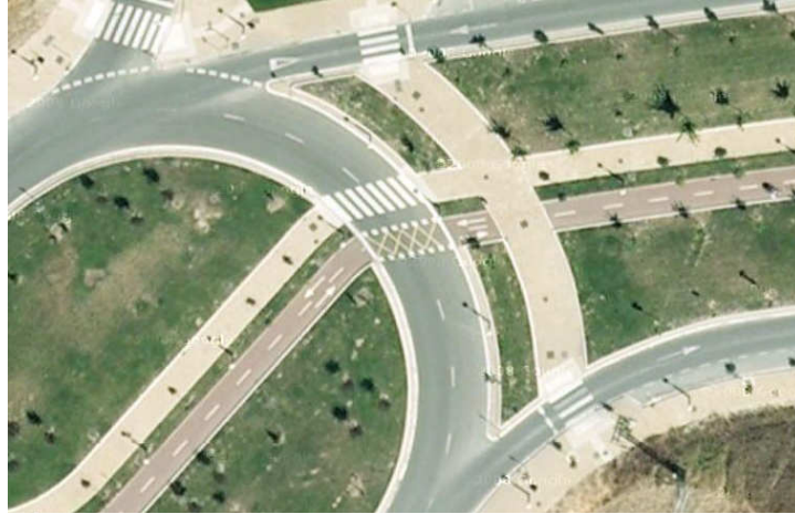
Paso ciclista interior de una glorieta (Calle Zumabide)
