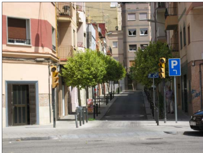
Mostra de cruïlla on els vehicles motoritzats entren a la plataforma única i existeix un semàfor per regular els fluxos de vianants que circulen per la via convencional.
