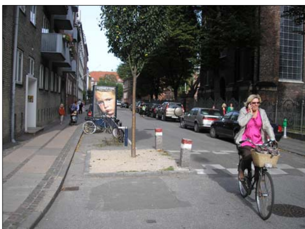
Estretament puntual de la calçada a través d'e l'arbrat i els escocells (esquerra) i estretament de la calçada coincidint amb un pas per a vianants en via de doble sentit de circulació motoritzada (dreta).
