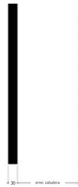
• Bizikleta bazterbideetarako bereizketa lerroa.
