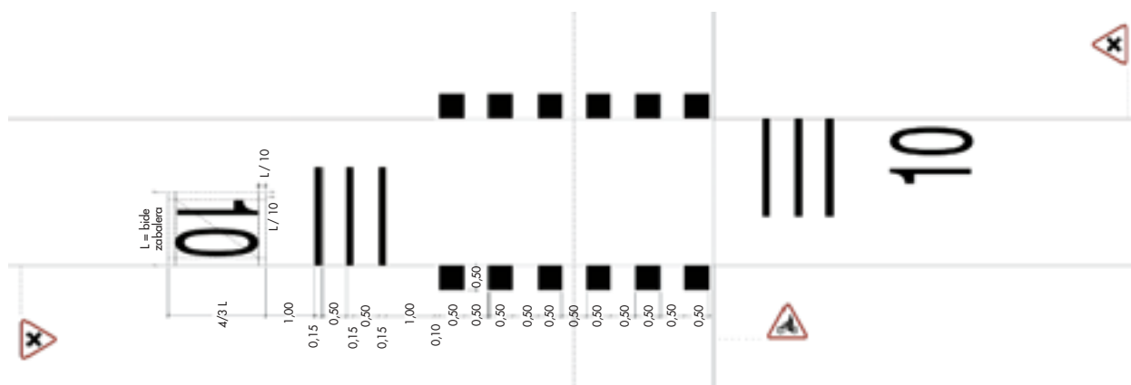
• 3. Kasua: pasabiderako lehentasuna duen bizikleta bide eta intentsitate ahuleko motordun bide edo oinezko bideren arteko bidegurutzearen seinaleztapena.
