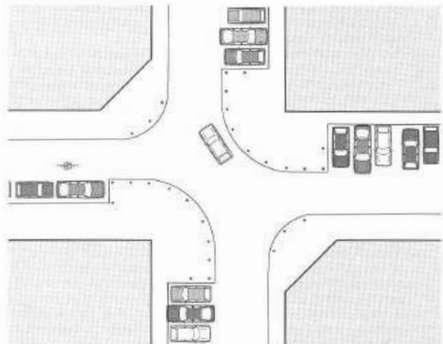
Intersección en zig-zag como ejemplo de dispositivo que reduce la velocidad del tráfico motorizado y lo equilibra con la de los ciclistas.
