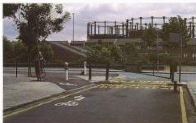
Desfiladeros para que las bicicletas eviten barreras de tráfico instaladas para crear áreas ambientales sin circulación de paso en Londres.
