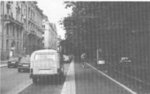
Pista-bici en Múnich (Alemania) netamente separada del espacio peatonal mediante arbolado y de la calzada mediante franja de aparcamiento.
