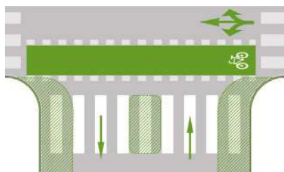
Imagen III. 37. Orejas y refugio peatonal en cruces con calles de dos sentidos de circulación
