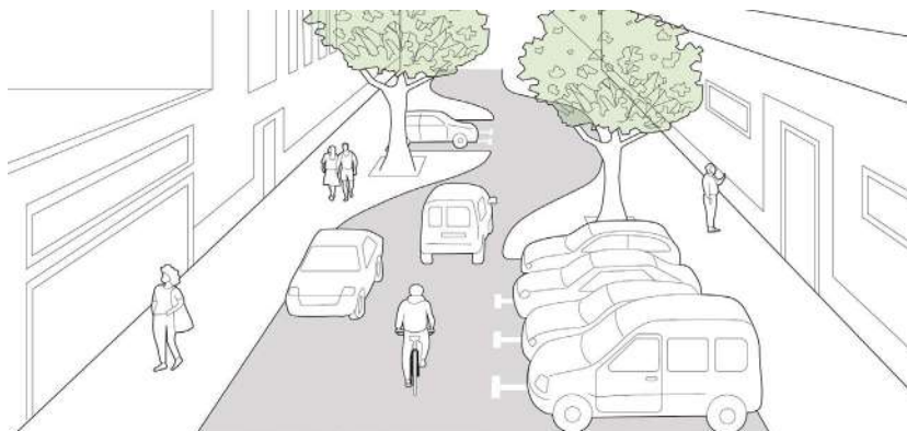
Imagen IV. 09. Zigzag en calzada bidireccional por alternancia de la banda de servicio
